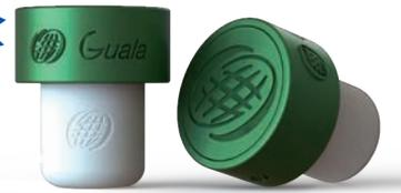
Questa chiusura è dotata di un nuovo concetto di Tamper Evident meccanico irreversibile. Al primo utilizzo parte della chiusura si abbassa di livello e rende evidente una banda colorata a testimonianza della avvenuta apertura.
